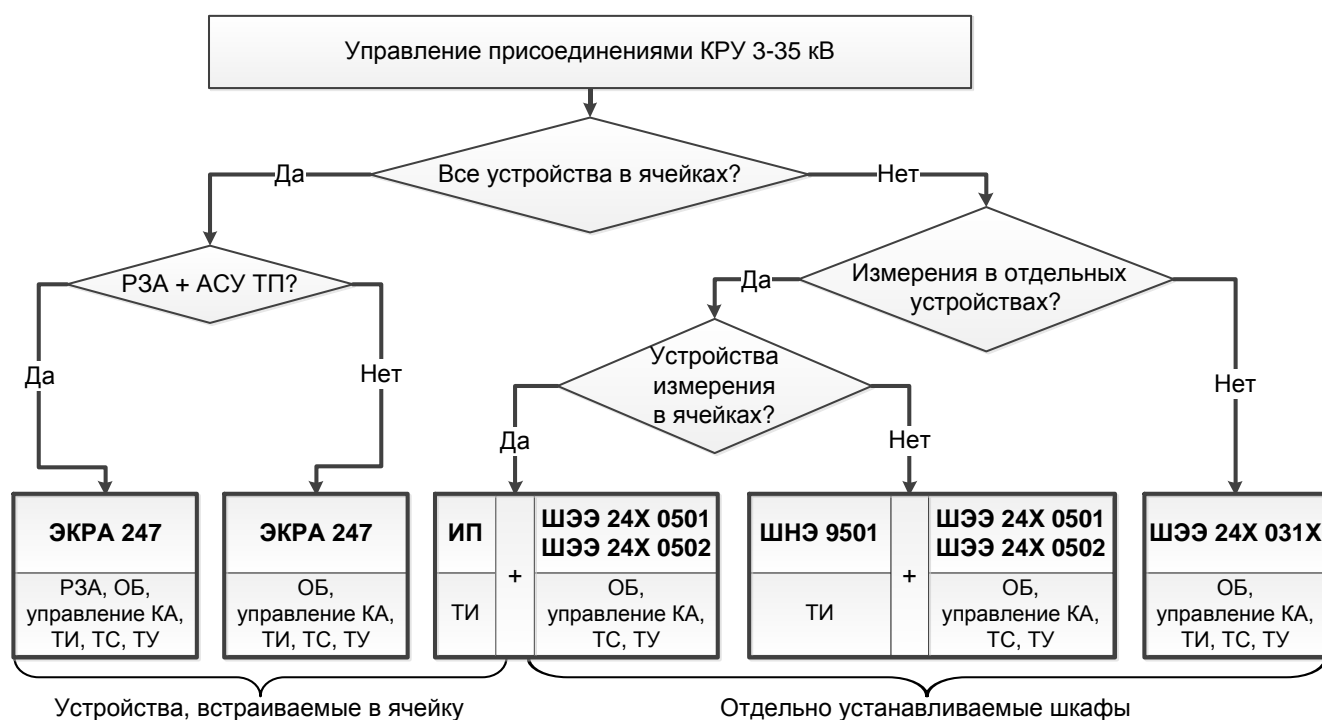
Рисунок 23 – Варианты расстановки устройств управления присоединением для КРУ 3-35 кВ
