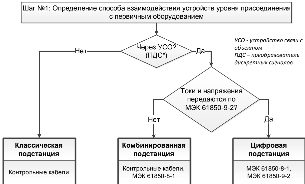
Рисунок 19 – Определение способа взаимодействия устройств уровня присоединения с первичным оборудованием
